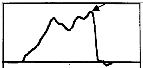
نمودار ۱: تفاضل منحنی بیناب انرژی بدون پراکندگی و آهنگ شمارش پایین از منحنی بیناب انرژی پراکندگی با ۱۰ سانتی متر آب و همان آهنگ شمارش
