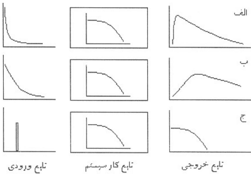
نمودار-۱: به هر سیستم می‌توان سه تابع ریاضی نسبت داد. سیستم تنها بوسیله یک (و) از این توابع بطور کامل قابل توصیف است. تابع سوم بوسیله معادلات ریاضی قابل محاسبه است. در مالت گل تابع سیستم ثابت است و تابع فروجی با تغییر تابع (رویدی (الف) و ب) تغییر می‌کند. تنها در صورتیکه تابع (رویدی بصورت تابع دیراک (ه)) باشد تابع فروجی با تابع سیستم یکسان است.
